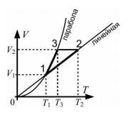
Учтем, что эти графики "работают" при  $V \in [V_1, V_2]$  (эти интервалы прямой и параболы мы выделили на рисунке жирным). Осталось только дополнить диаграмму горизонтальным отрезком 2-3, на котором по условию объем не меняется.
